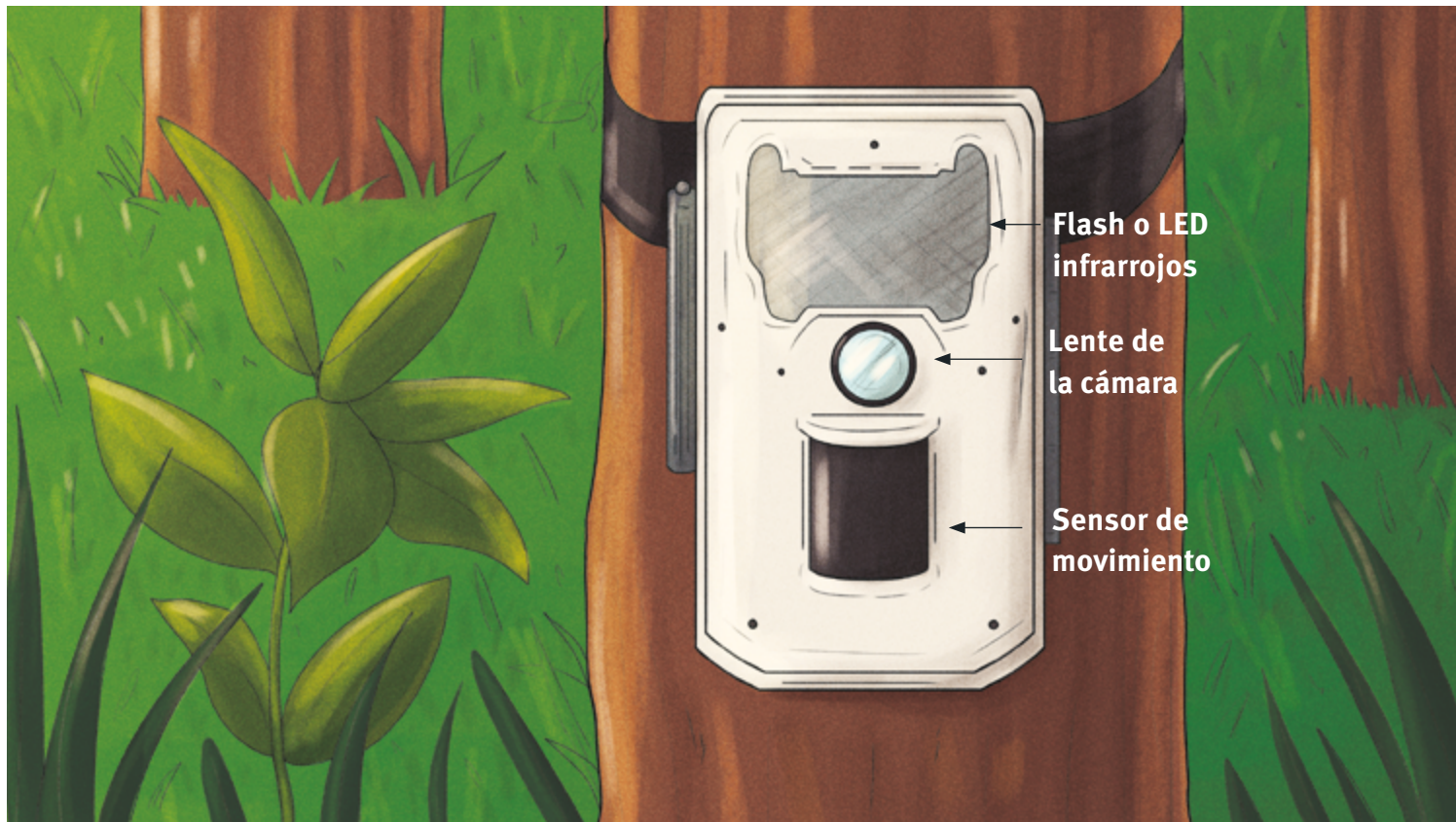
Figura 3. Explicación de las partes de la cámara trampa.
